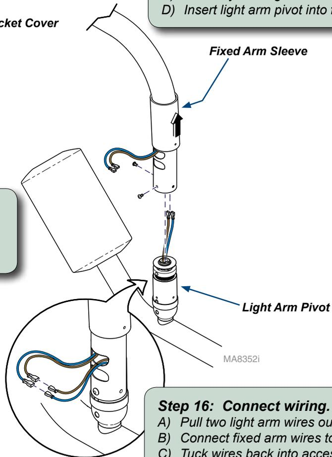
**Step 16: Connect wiring.**
